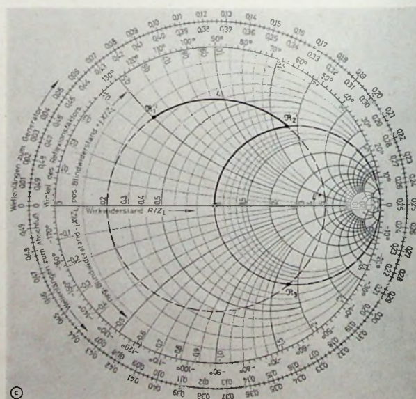
Bild 17. Transformation des Widerstands R_1 in den Wellenwiderstand durch ein Leitungsglied der Länge L und einen induktiven beziehungsweise kapazitiven Reihewiderstand; a) Transformationsprinzip bei kapazitivem, b) bei induktivem Reihewiderstand, c) Diagrammeintragen
